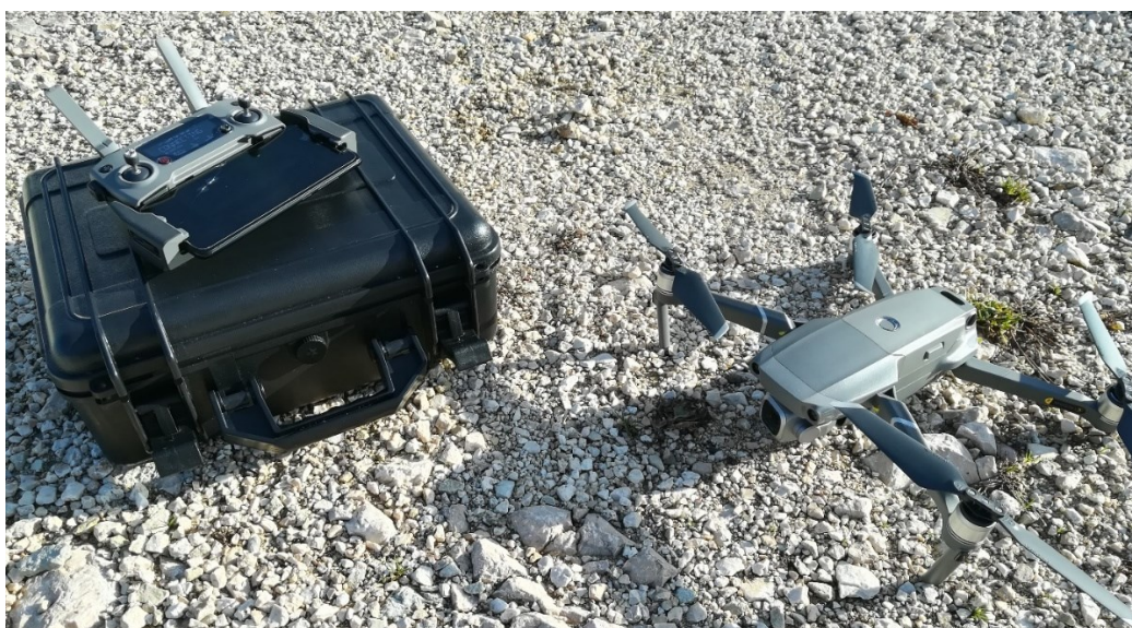
Figura 1.1 – Strumentazione utilizzata per i rilievi geomorfologici, per l’acquisizione di immagini in volo per la successiva elaborazione e restituzione fotogrammetrica.
